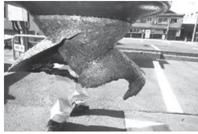
破損したプロペラ
