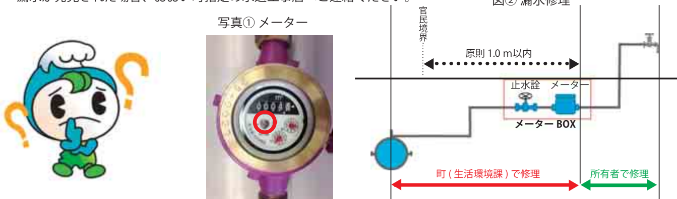
図② 漏水修理
